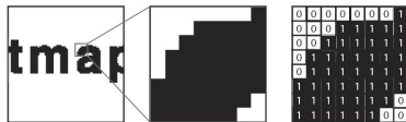
Figura 1.2 Un ingrandimento della matrice di bit visualizzata sul monitor e i bit corrispondenti per ogni pixel.
